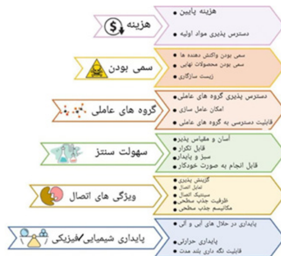
شکل ۲. نکات مهم برای انتخاب مواد کاربردی برای تهیه کامپوزیت های مبتنی بر MIP
