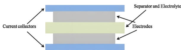
شکل ۱ ساختار داخلی یک ابرخازن [۱].
