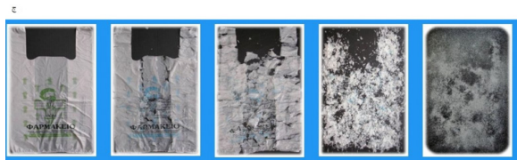
شکل ۱ الف) کیسه پلاستیکی اکسو تخریب‌پذیر در زمان صفر (حالت
